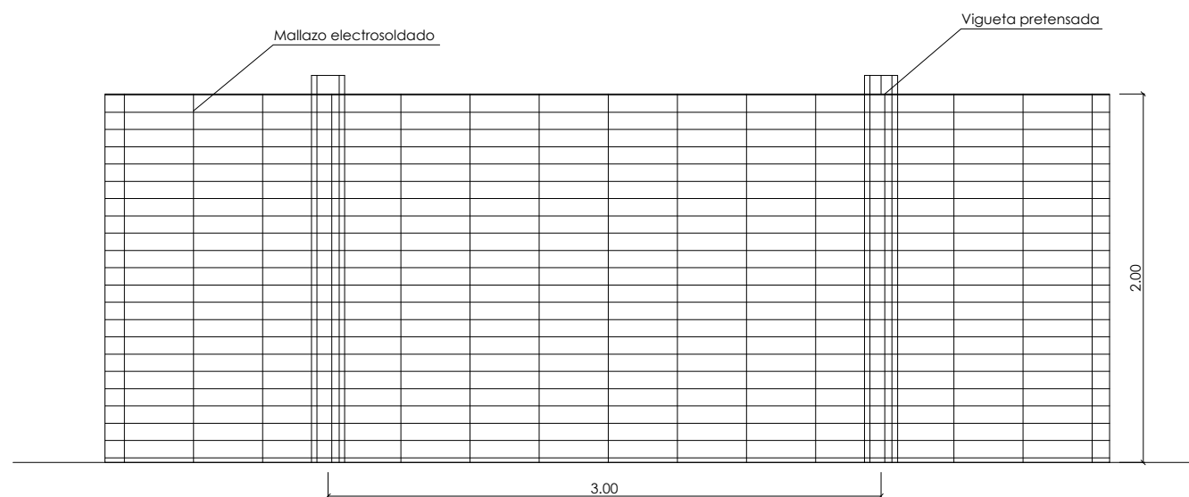
VALLA CON MALLAZO METALICO
