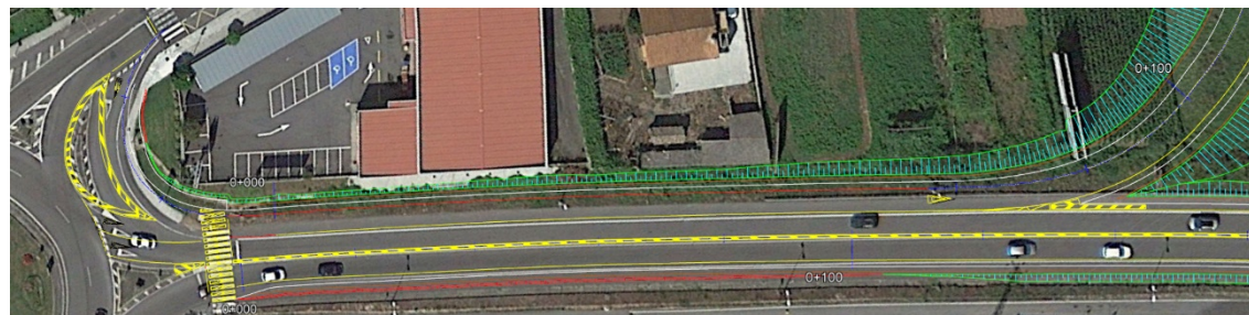
Ampliación de carril de la PO-504
